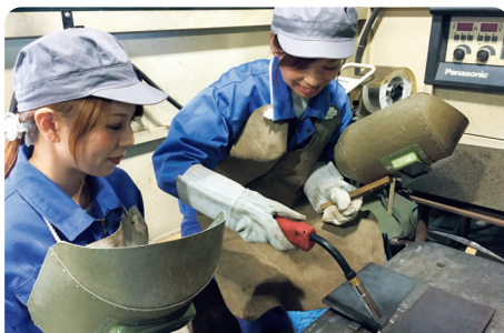
炭酸ガスアーク溶接作業
