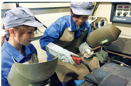
炭酸ガスアーク溶接作業
