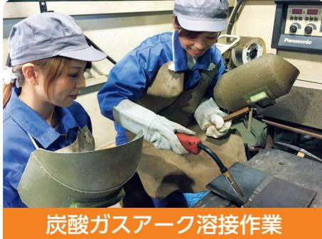
炭酸ガスアーク溶接作業
