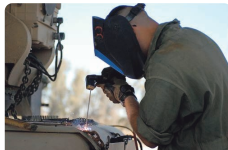
被覆アーク溶接作業
