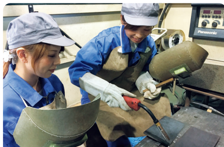
炭酸ガスアーク溶接作業
