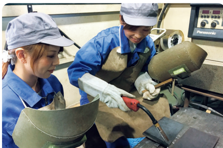
炭酸ガスアーク溶接作業
