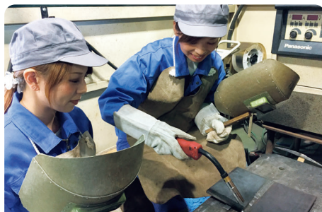
炭酸ガスアーク溶接作業
