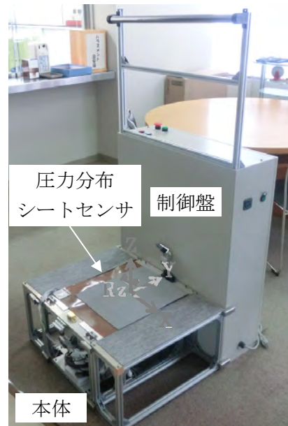
図7 システム構成 (2号機)
