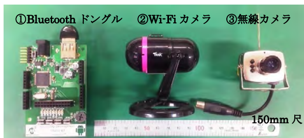
図17 信号観測に使用したデバイス
