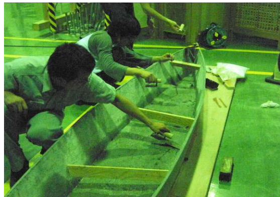
図2 船底打設の様子
