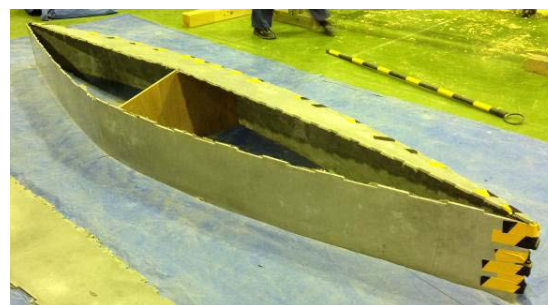
図3 側面・底面はめ込み作業
