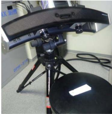
図5 非接触三次元測定機による測定
