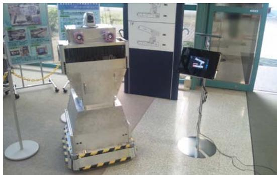
図1. 案内ロボット・操作端末外観
