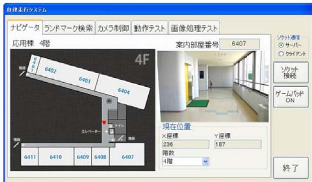
図3. 自律走行システムの監視制御画面
