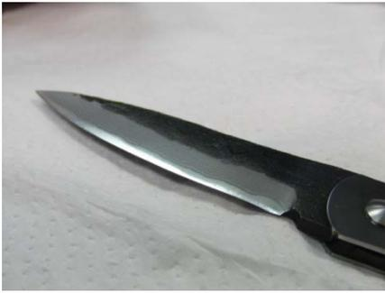
図2 製作したダマスカス刃物
