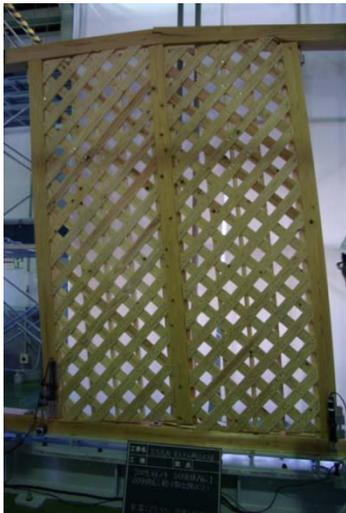
図6 予備試験体(格子70ビス)試験終了写真
