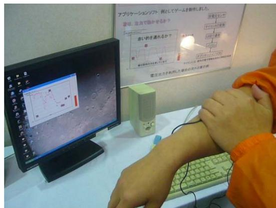
図 2 筋電位の測定方法
