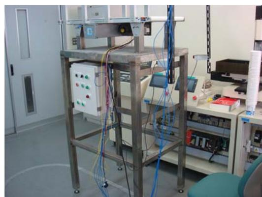
図 5 ベルトコンベア・制御ボックスを付けた台
