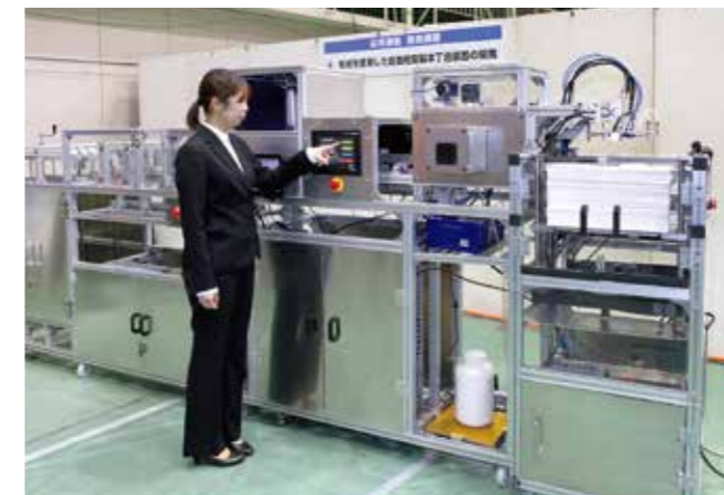
④ 和紙を使用した自動蛇腹製本丁合装置の開発
