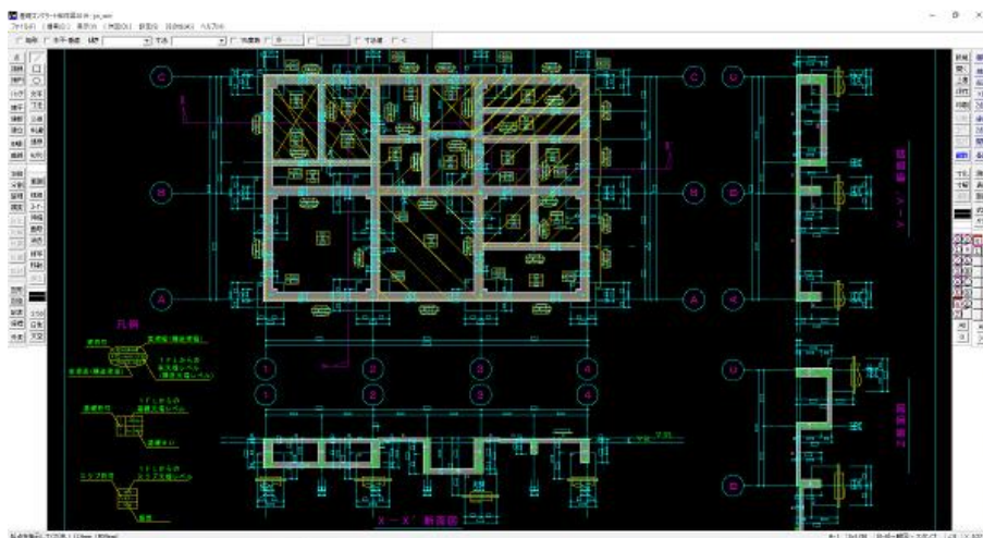
図 施工図の作成例 (Jw_cad)
