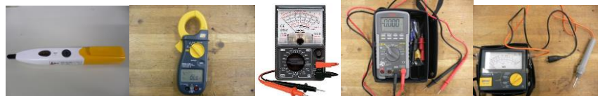
検電器 クランプメータ テスタ 回路計 絶縁抵抗計
