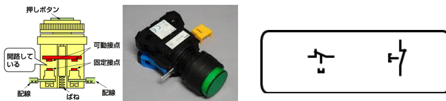
写真-4 部品の動作と回路図記号（押ボタンスイッチの例）
