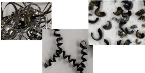
図1 実験1 送り速度と切り屑の状態
