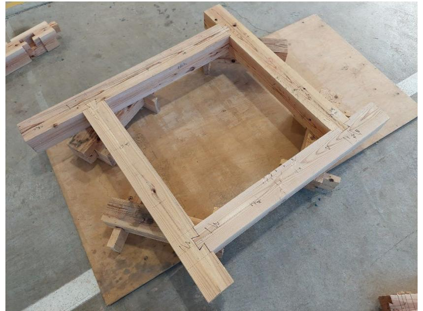
手工具により木材を加工するための技術を習得します。写真は製材から四人が同じ部材を作成・加工し井桁に組んだ状態です
