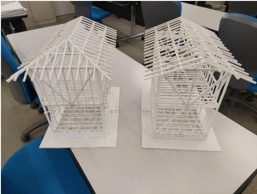
模型作成を通じて、在来軸組み構法の構造部材の名称と、建てる順序を身につけます。
