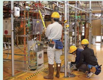
高圧受変電設備の図面を読むための知識を習得し、設備を構成する各種開閉器や保護継電気の設置・接続から、各種試験を実施するのに必要な知識と技能・技術を習得します。
