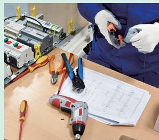
有接点リレーシーケンス回路中に制御専用のPC(FPGA制御専用プログラマブルコントローラ)を組込み、利用するための技能・技術を習得します。
