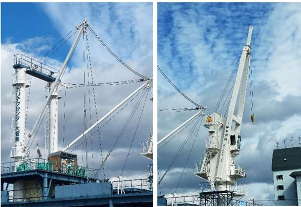
図1 揚貨装置 (左:デリック形式、右:ジブクレーン形式)
