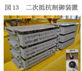
図13 二次抵抗制御装置
