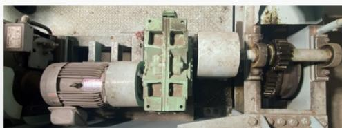
速度  $m/min = 1110\ rpm \times 1/9.778 \times 18/40 \times 0.315\ \pi \times 設定\ Hz / 60Hz$
