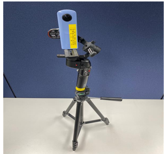
図2. 実際に使用した機材 3軸スタビライザーmini-p Max 360Camera RICOH THETA
