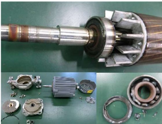
ポンプ用モータのトラブル例
