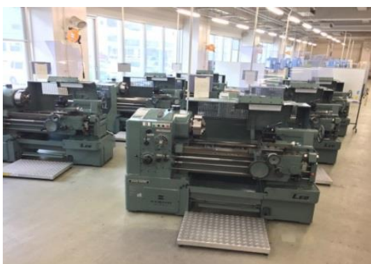
実際に使用する普通旋盤 (DMG 森精機ワシノLEO-80A)
