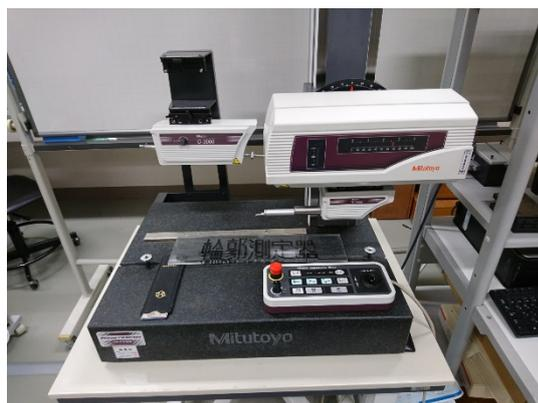
輪郭形状測定機 FORMTRACER SV-C3100
