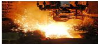
高炉から溶けた鉄を取り出す「出銑」
