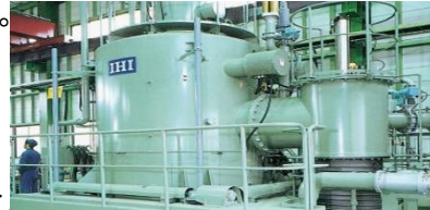
西日本最大級の焼入れ真空炉 航空機・船舶など様々な大型部品で活用
