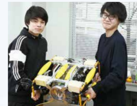
耐圧性、水流抵抗などを考えて設計。コントローラはゲーム機から流用。
