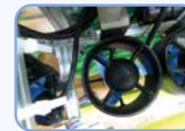
推進力を生み出すスラスタ。8基をマイコン制御している。
