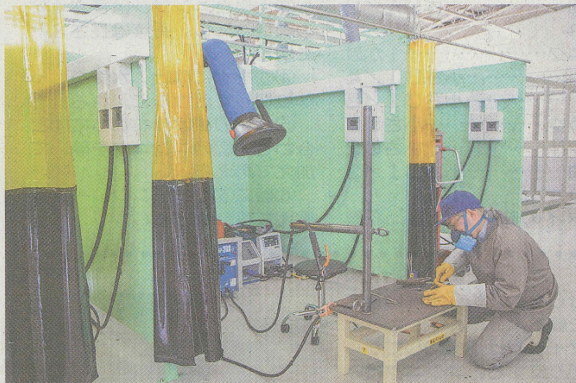
ものづくり機械科新設に合わせ、センター内に設置した溶接の実習ブース
