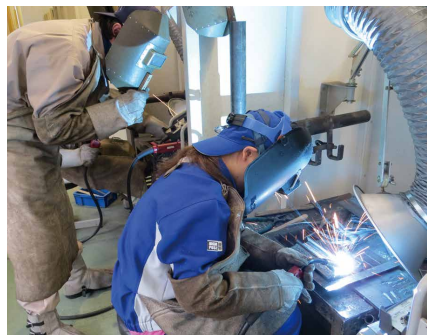
炭酸ガスアーク溶接
