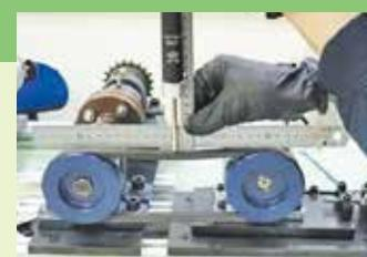
ベルトの適正な張り調整
