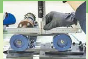
ベルトの適正な張り調整
