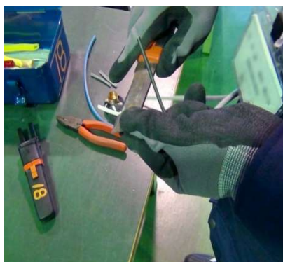
電工ナイフでの電線加工
