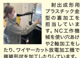
射出成形用プラスチック金型の裏加工を担当しています。NC工作機械を使い穴あけや2軸加工をしたり、ワイヤーカット放電加工機で複雑形状を加工したりしています。
