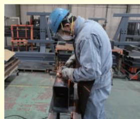
現在は開先加工（溶接する部分を適切な形に加工すること）、本溶接、サンダー仕上げ（溶接後の盛り上がりや平らにすること）を担当しています。
