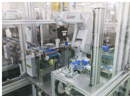
組立・仕分ステーション
