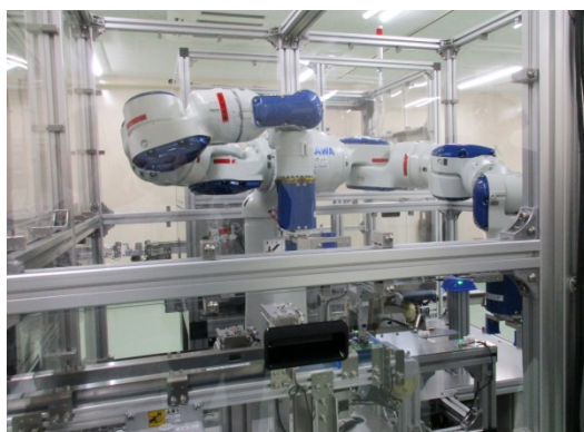
外観判別ステーション
