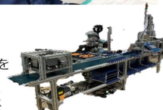
開発課題で製作した 協働ロボットを用いた 弁当盛り付けシステム
