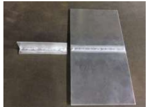
各種板厚による溶接施工
