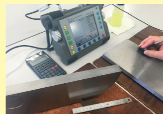
▲溶接部の超音波探傷試験
