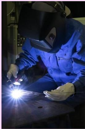
午後は、TIG溶接作業の訓練です。トーチの角度や溶接速度に細心の注意を……。もちろん安全作業を心がけます。出来栄は、自分の目で確かめて！！
