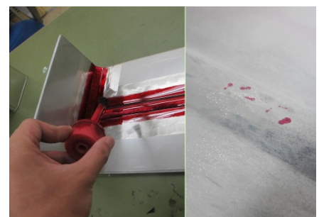
【※写真は、試験片に浸透探傷試験を行った結果の例】 浸透液（赤色）により溶接欠陥箇所を検出します。
