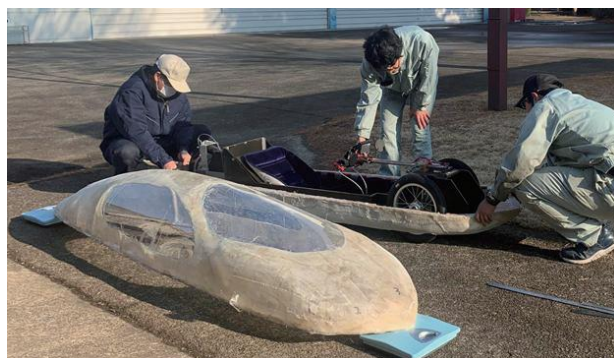
図10 キャノピーを成形したボディカウル
