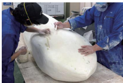
図8 雄型製作の様子
