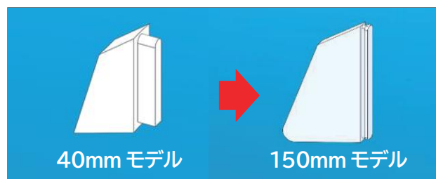
図 5 手の丸みの設計変更
