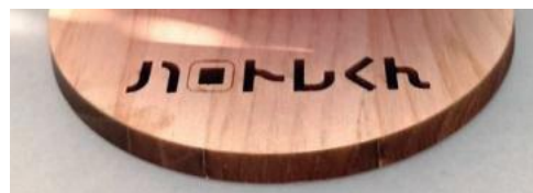
図 7 ロゴのレーザ加工
