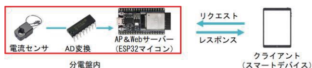
図9 Web通信の概略図
