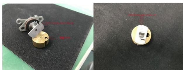
図2 アイドルバルブプレート及び調量ジェット(左)、ミクスチャコントロールプレート(右)
