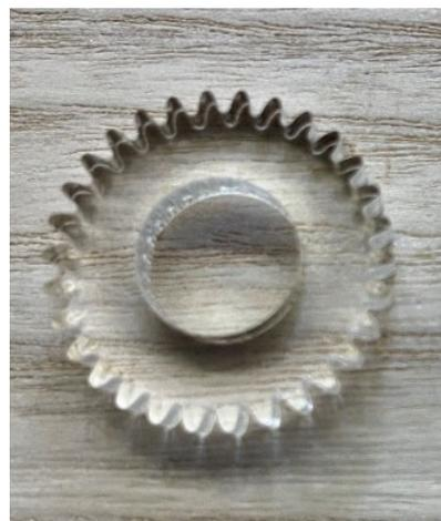
図 5 レーザ加工機で作製した歯車
