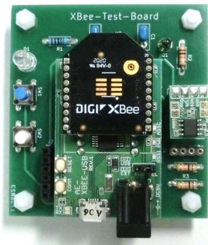
図 4 ワイヤレスネットワーク構築実習デバイス
