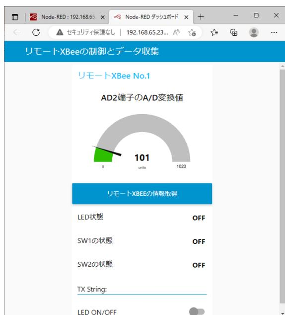
図 7 測定、遠隔制御用のアプリケーション画面
