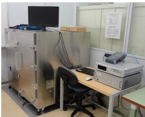
図8 放射ノイズ測定システム
