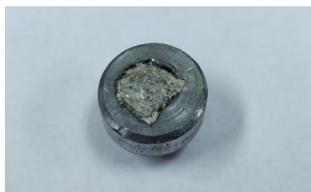
図2 探り式鉱石検波器 (方鉛鉱)
