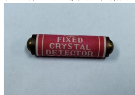
図3 固定式鉱石検波器
