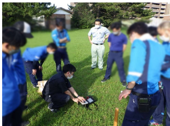
図 3-7 接地極の接地抵抗測定
