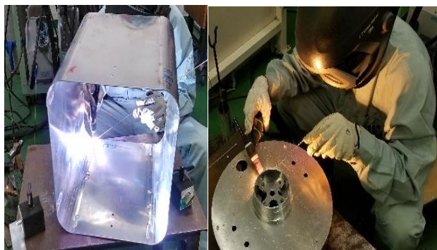
図1 ボディの溶接 図2 蓋とフィルター
