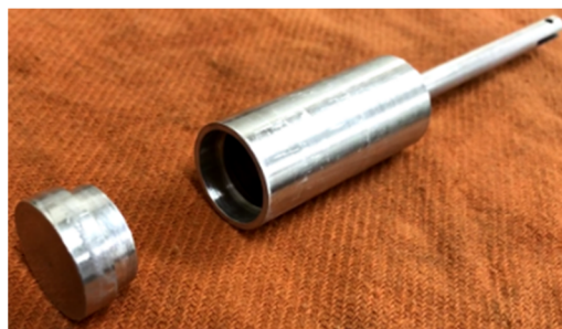
図8 軽量化・一体部品化後のディスプレイサ
