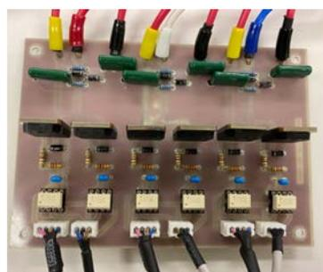
図 2 三相フルブリッジインバータ部の外観のデメリットがある。また、スイッチング時のサージ電圧やモータからの逆電圧の影響と想定される IC の焼損が多く見られ、故障率が高いという問題があった。本稿ではハイサイド側のゲート駆動電圧に相毎に絶縁型 DCDC コンバータを用いて 12V の電圧を、ローサイド側には 3 相分を一括して 1 つの DCDC コンバータで給電している。これにより、ハイサイド側に Nch-MOSFET を使用できる他、duty 比やスイッチングパターンを任意に設定することができる。
