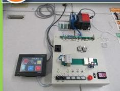
プログラム設計の、各種センサの接続方法、タッチパネルの画面設計など、コンピュータを用いて電気機械を制御する技術を習得します。
